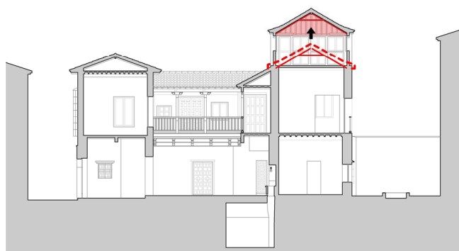
Fig.74: Esquema ilustrativo en sección del añadido de la torre-secadero y reutilización parcial de la armadura del salón inferior. Elaboración propia.
